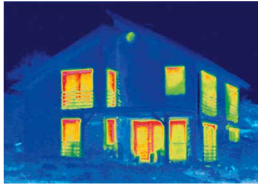
Infrarotaufnahmen zeigen deutlich, wo ein Haus unkontrolliert Energie verliert. Rot bedeutet Wärme und damit hohen Energieverlust.
